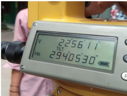
Gambar 5 : *theodolite* telah mengarah ke arah kiblat
