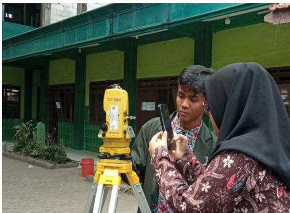
Gambar 1: *Theodolite* telah dipasang dengan baik
